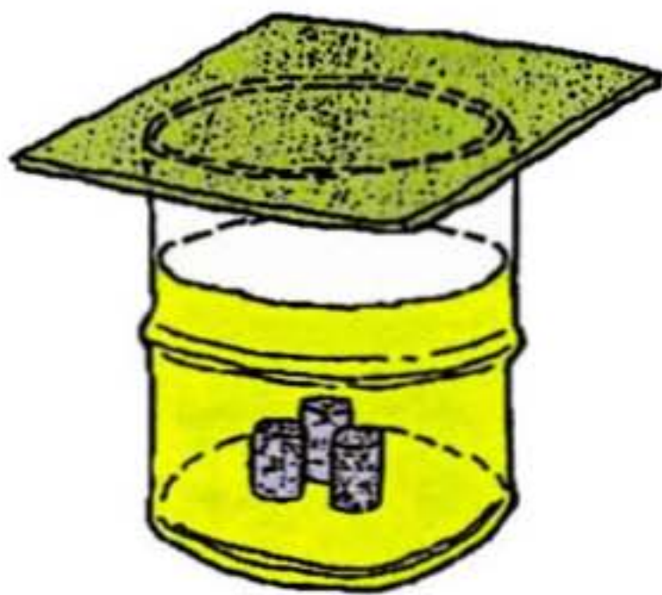
混凝土試體進行養生作業
