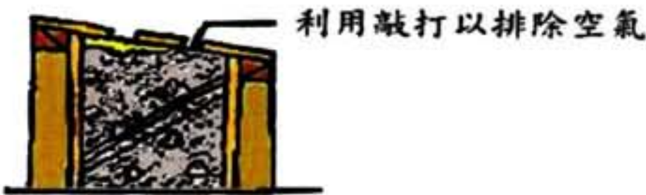
圖 4. 49 開氣孔及確認填實
